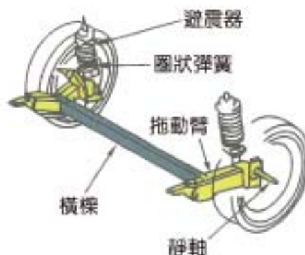
圖 2-154 前輪驅動式後軸（拖動臂式）（Automechanics fundamentals）
