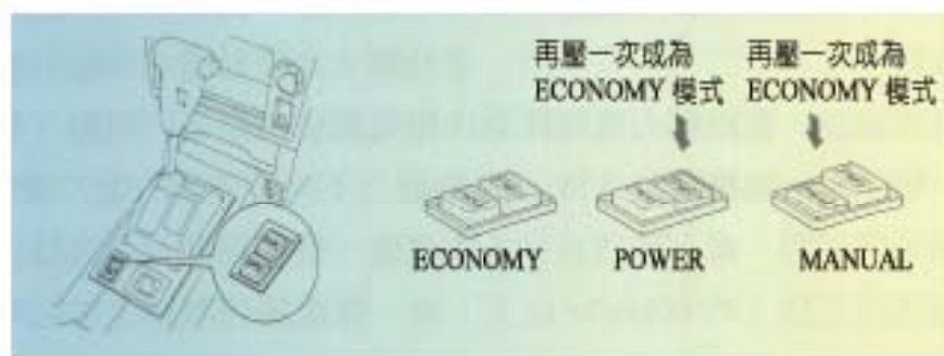
圖 2-95 模式選擇開關的位置 (AT 車的變速箱) (Automechanics fundamentals)
