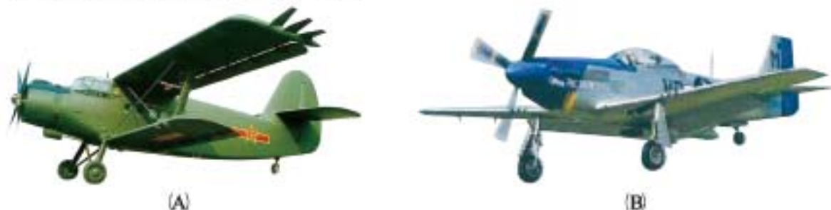
圖 8-2 後三點式起落架 (航空器概論)
