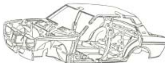
圖 3-8 單體式結構（整體式車身）（自動車工學）
