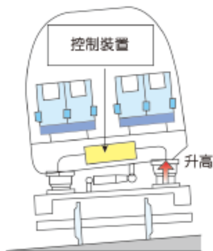
圖 8-29 過彎時自動調整高度及水平（鐵道的科學）
