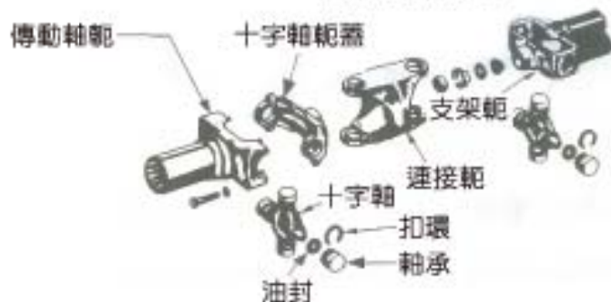
圖 2-119 雙十字軸及軛型等速萬向接頭 (現代汽車底盤)
