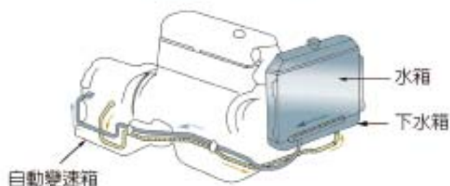
圖 2-81 自動變速箱油的冷卻裝置 (自動車設計)
