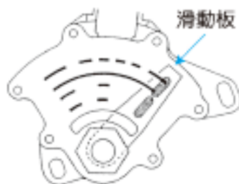
圖 2-97 空檔起動開關的構造及作用 (CIVIC 修護手冊)
