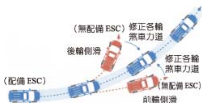
圖 7-1 車身穩定系統 ESC 之作用 (NISSAN 修護手冊)
