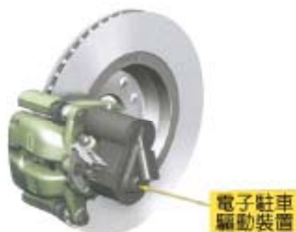
圖 6-67 鉗夾整合式 EPB 系統 (網路-龐科技)
