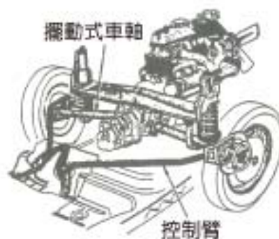
圖 3-48 擺動車軸式獨立懸吊裝置（汽車學2）
