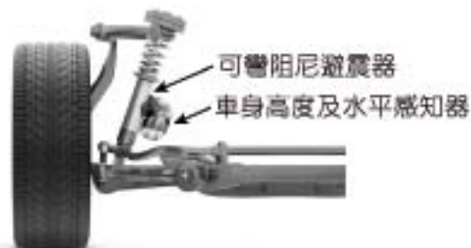
圖 3-53 數位懸吊系統配置圖
