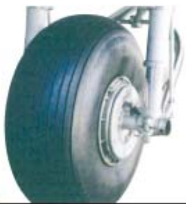
圖 8-9 飛機縱向胎紋（航空器概論）
