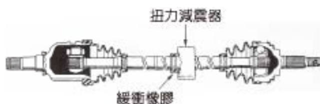
圖 2-153 扭力減震器的位置（Automechanics fundamentals）
