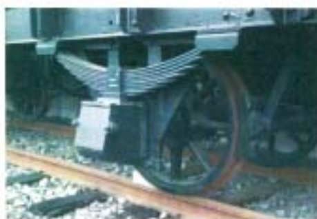
圖 8-27 載貨列車之片狀彈簧懸吊（鐵道的科學）
