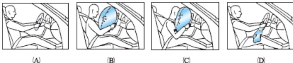
圖 7-7 SRS 之作用過程（以 50 km/h 固定壁作正面撞擊）（CIVIC 修護手冊）
