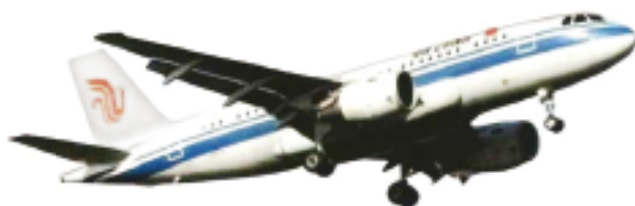
圖 8-1 前三點式起落架（航空器概論）
