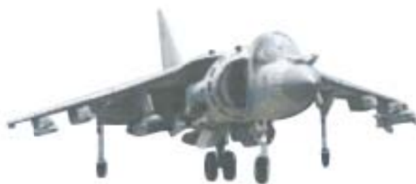
圖 8-4 自行車式起落架（網路—每日頭條）
