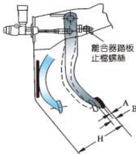
圖 2-21 離合器踏板自由行程 (NISSAN 修護手冊)
