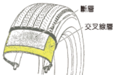
圖 5-23 交叉層輪胎 (Automechanics fundamentals)
