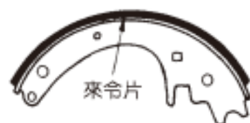
圖 6-30 使用膠合之煞車來令片 (汽車學 2)
