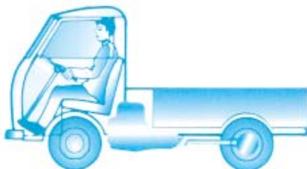
圖 1-10 MR 式車輛底盤（自動車整備）
