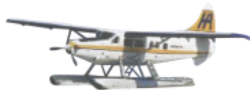
圖 8-6 浮筒式起落架（航空器概論）
