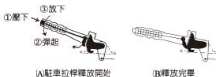
圖 6-63 駐車煞車拉桿定位裝置 (TOYOTA 修護手冊)
