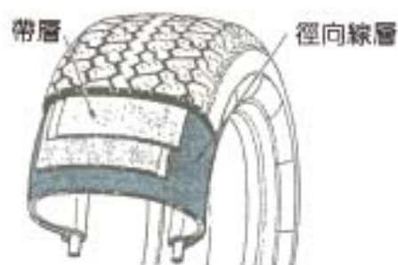
圖 5-24 徑向層輪胎 (Automechanics fundamentals)
