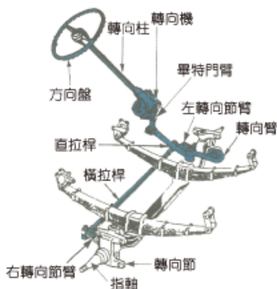
圖 4-5 整體式懸吊之轉向系統 (汽車學 2)
