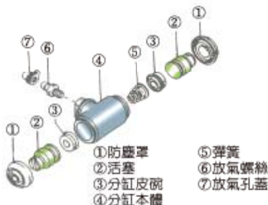
圖 6-18 煞車分缸之構造 (自動車工學)
