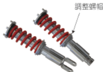
圖 3-38 可調式避震器 （Automotive mechanics）
