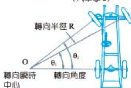
圖 4-4 轉向瞬時中心、轉向半徑及轉向角度 (自動車設計)
