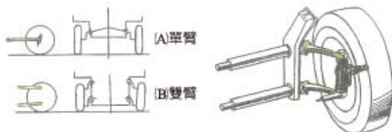
圖 3-47 拖動臂式獨立懸吊裝置（Automechanics fundamentals）
