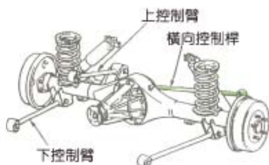
圖 3-43 橫向控制桿（偏斜桿）（現代汽車底盤）
