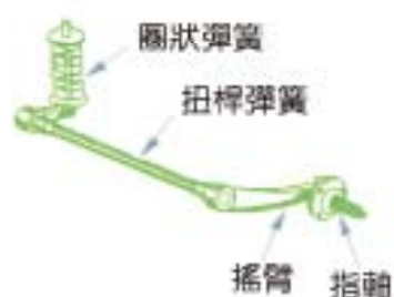
圖 3-20 扭桿與圈狀彈簧之複合彈簧 (三級自動車シャーシ)
