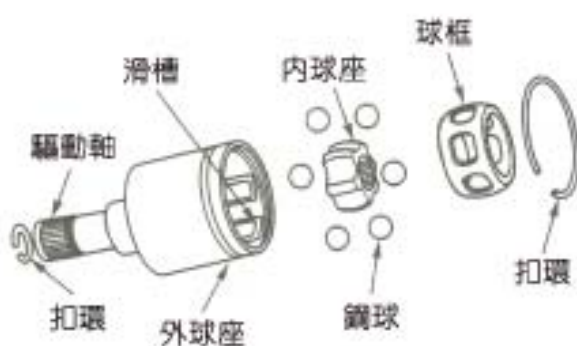
圖 2-116 雙偏位型等速萬向接頭 (三級自動車シャーシ)
