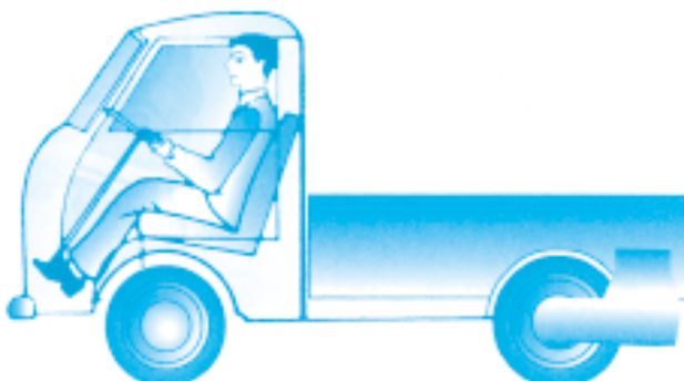
圖 1-11 RR 式車輛底盤（自動車整備）
