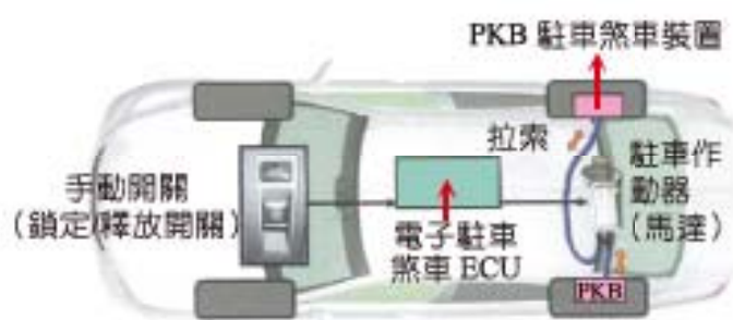
圖 6-66 鋼索牽引式 EPB 配置圖 (網路-龐科技)
