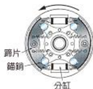
圖 6-36 複動雙引導式蹄片安裝法 (ブレーキ)
