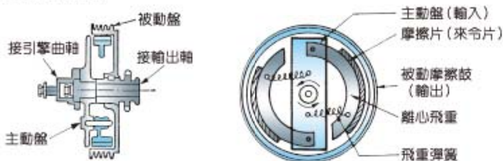
圖 2-22 離心力式自動離合器的構造及作用
