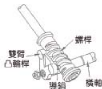
圖 4-13 螺桿與凸輪桿式轉向機 (現代汽車底盤)
