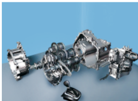
圖 2-100 AUDI DSG 6 速自、手動變速箱 (U-Car)
