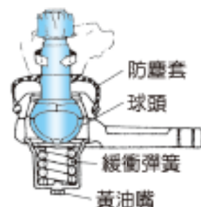
(B)球接頭的構造 (橫拉桿)
