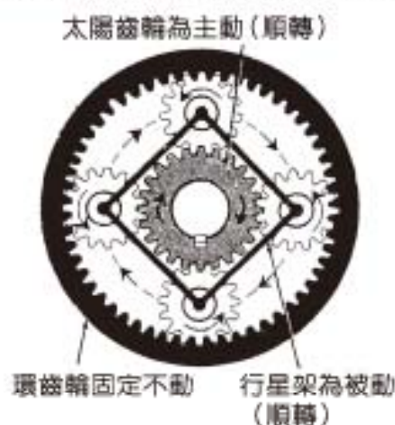
圖 2-70 行星齒輪的轉動方向 (現代汽車底盤)
