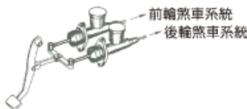
圖 6-55 並列式煞車主缸（現代汽車底盤）
