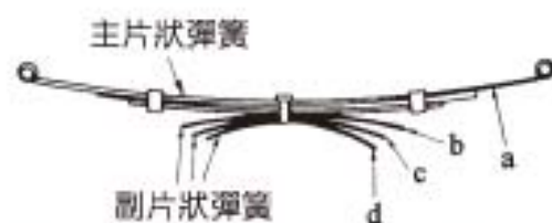
圖 3-13 多段式片狀彈簧 (自動車設計)
