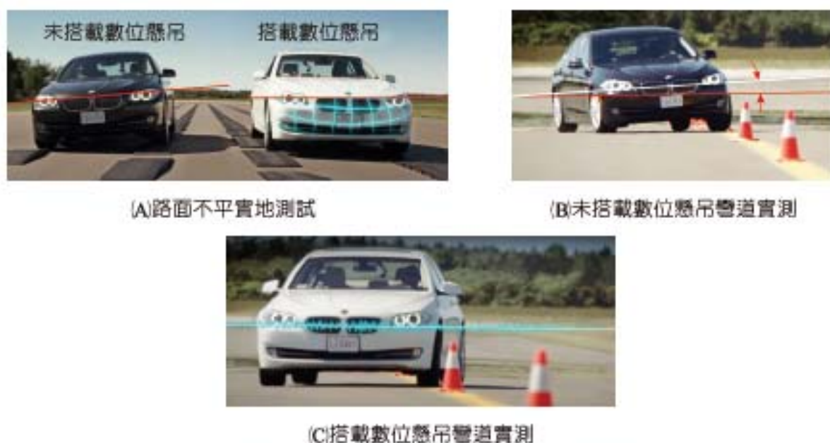
圖 3-52 未搭載與搭載數位懸吊實車測試比較
