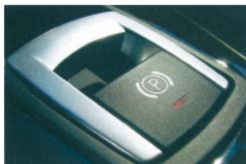
圖 6-65 電子駐車煞車按鈕 (網路-繼科技)
