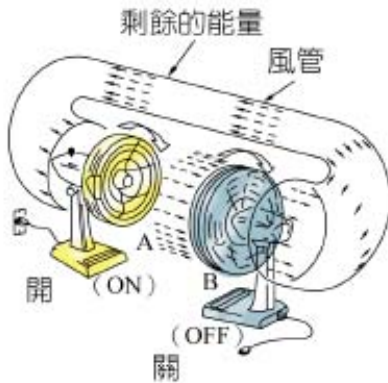
圖 2-57 液體扭力變換器之作用原理 (AT 車的すべて)
