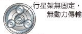
圖 2-89 “D 1 ” 檔各組件的作用 (NISSAN 修護手冊)
