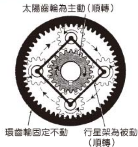
圖 2-70 行星齒輪的轉動方向 （現代汽車底盤）
