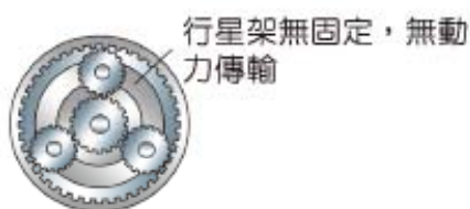
圖 2-90 “D 2 ” 各組件的作用 (NISSAN 修護手冊)
