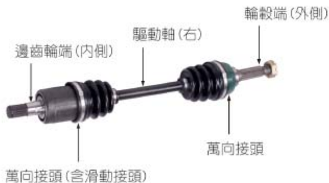
圖 2-108 驅動軸的構造（網路-大陸運輸機械）
