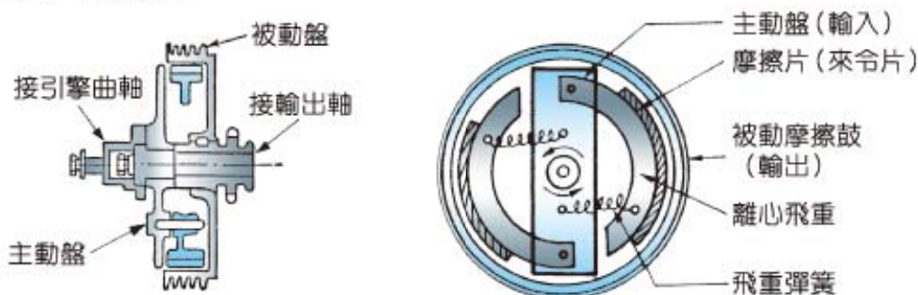
圖 2-22 離心力式自動離合器的構造及作用
