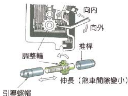
圖 6-39 棘輪式煞車間隙調整裝置 (三級自動車シャーシ)
