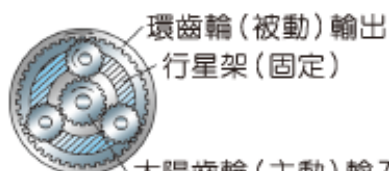
圖 2-91 1 1 排檔位置時各組件的作用與動力傳遞 (NISSAN 修護手冊)
