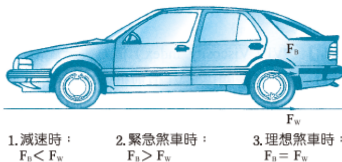
圖 6-5 制動力、胎地摩擦力與煞車效果的關係（現代汽車底盤）
